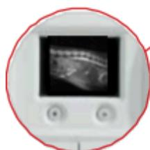
A aquisição em \*tempo real permite que o operador verifique o posicionamento do paciente diretamente do monitor do sistema.
